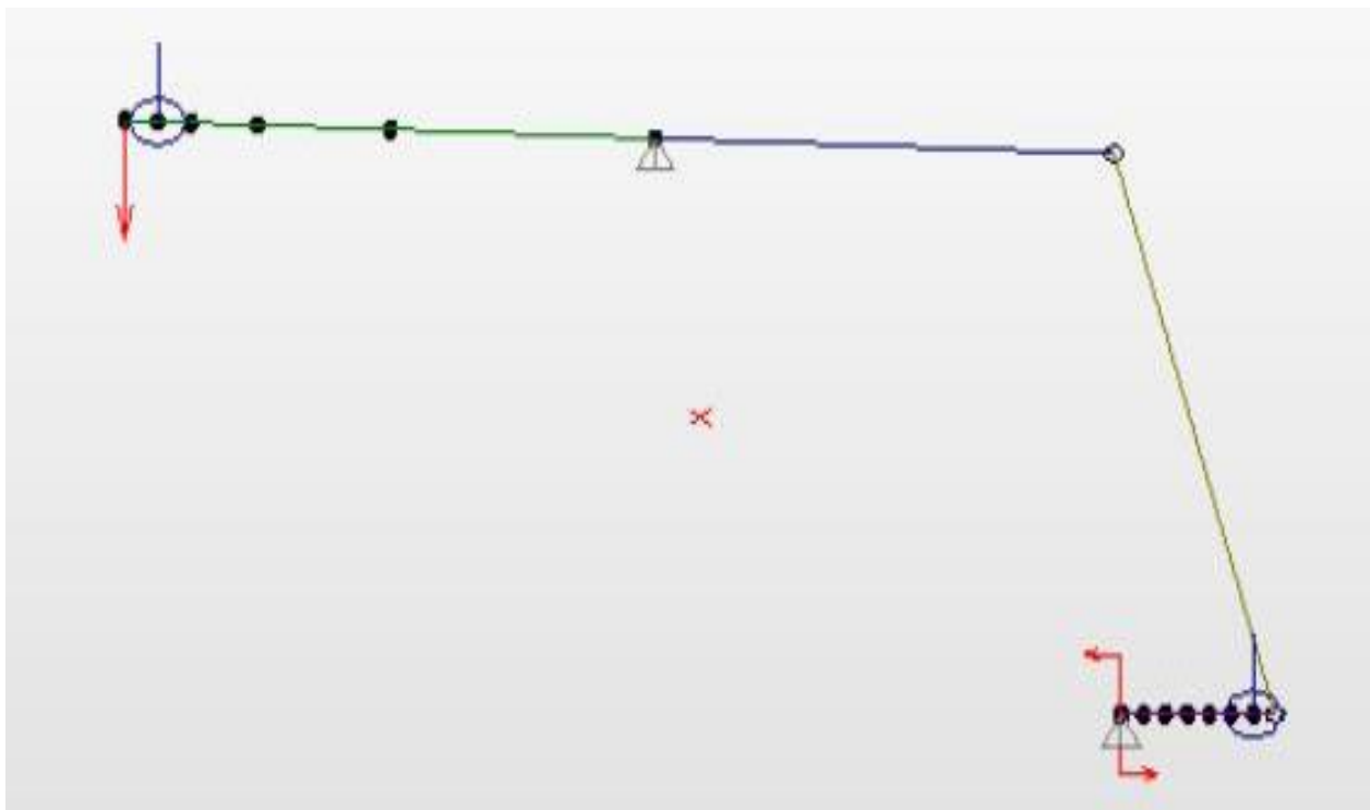
3.3 – сурет – \varphi_2 = 0^\circ -ке тең болған жағдайдағы АРМ Win Machine бағдарламасындағы механизмнің кинематикалық сұлбасы
